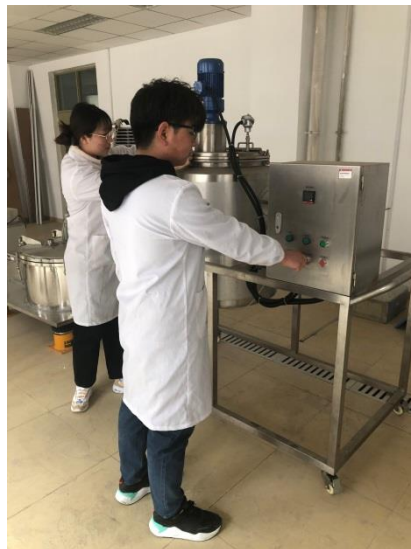
图4 海洋资源开发利用实验室工程 设备-微藻培养液巴氏杀菌装置
